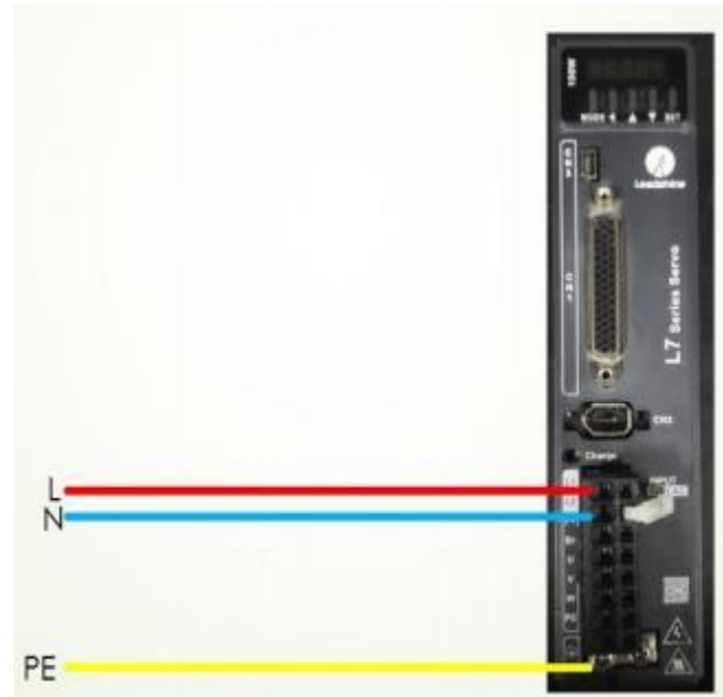
②伺服驱动器电源接线（单相220V）
