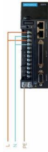
②伺服驱动器电源接线（单相220V）。
