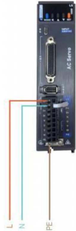
②伺服驱动器电源接线（单相220V）。
